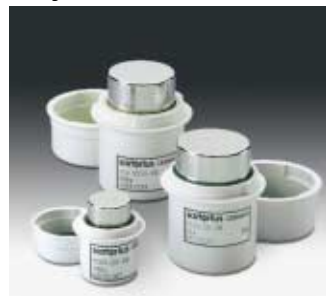
Prüfgewichte in Zylinderform nach OIML
