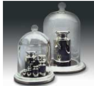
Glasglocken zur Aufbewahrung von Gewichtsnormen von 1 mg bis 50 kg
